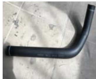
膨胀水箱回水胶管
