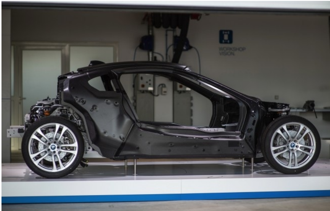
图 2 BMW i8 全 CFRP 碳纤维增强复合材料乘员舱
